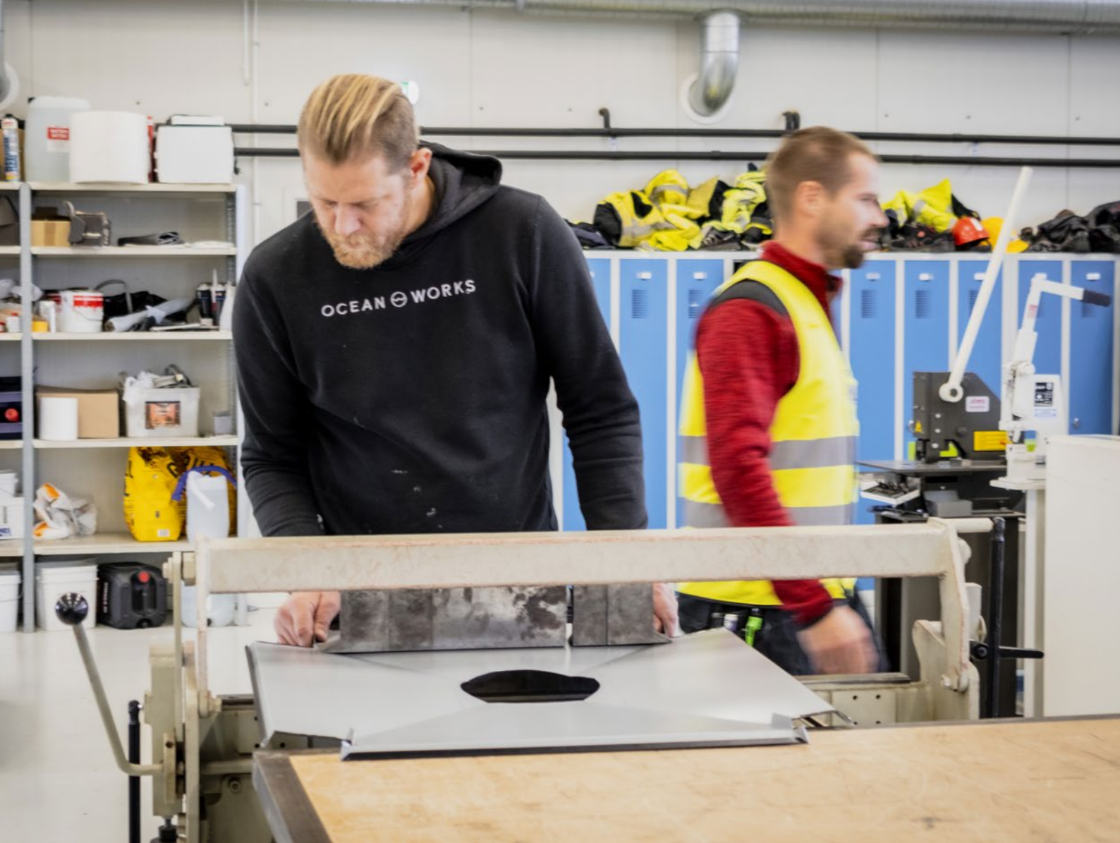
I verkstaden bockar Michael Servin plåt till en skorstenshuv. Patrik Larsson skymtar i bakgrunden.
